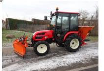
Traktor Branson 3100H Hydrostat Kabine Fronthydraulik Winterdienst
