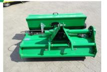
Saatkasten Seeder für Bodenumkehrfräse Geo SB165
